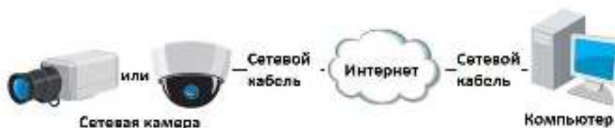
Рисунок 2-11 Доступ напрямую к видеокамере со статическим IP-адресом
