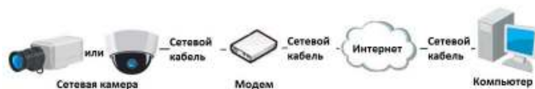
Рисунок 2-12 Доступ к видеокamере с динамическим IP-адресом
