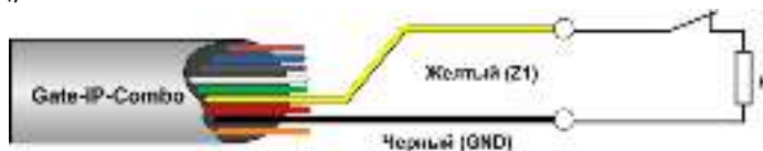
Рис.16. Подключение дверного контакта
