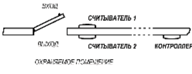
Рисунок 12 – Расположение устройств в варианте подключения 3
