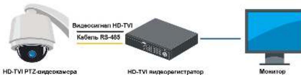
Рис. 1.9. Типичная схема управления через видеорегистратор
