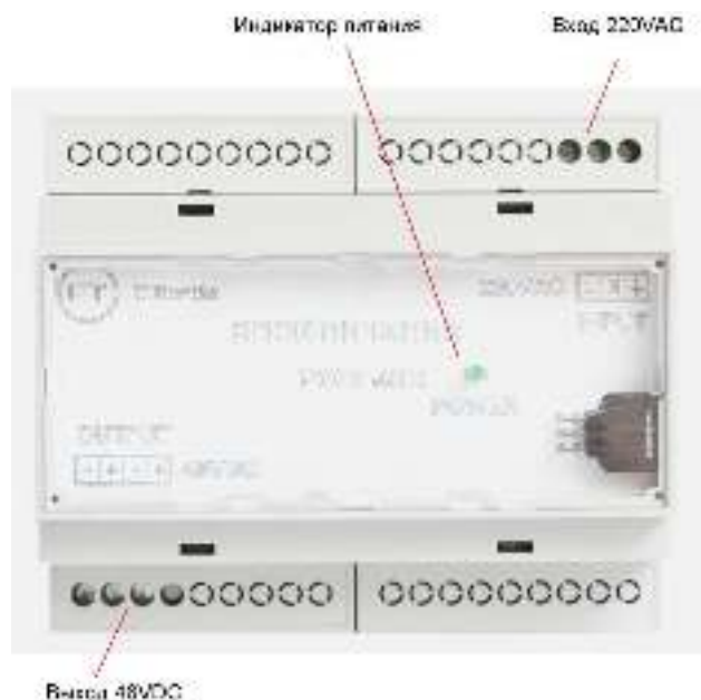
Рисунок 2.2-1. Расположение элементов PWR-48D
