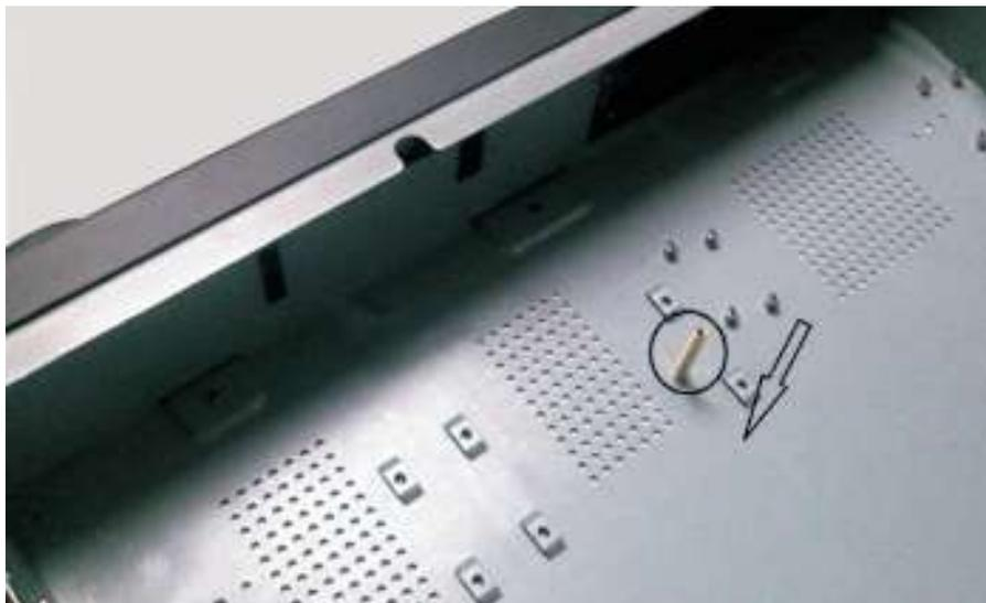
3. Установите нижнюю монтажную планку и затяните винты нижнего жесткого диска.
