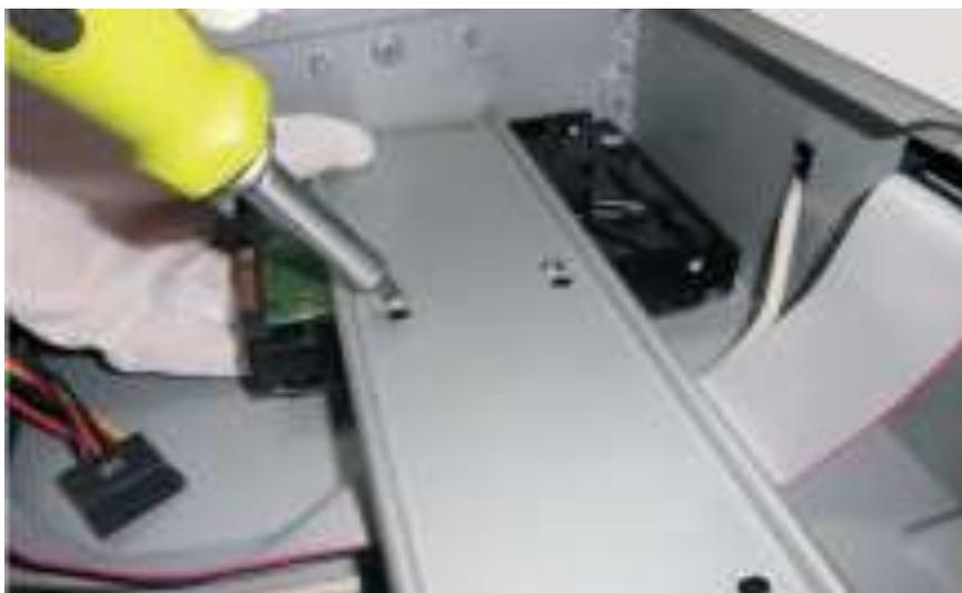
4. Подключите кабель питания и шлейф SATA к жесткому диску. Повторите ту же последовательность действий для установки 3 других жестких дисков.
