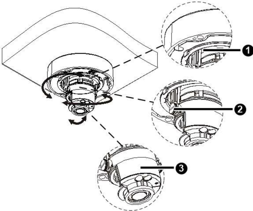
4. Установите прозрачный купол камеры, вкрутив 3 винта, встроенные в его края, в отверстия основания:
