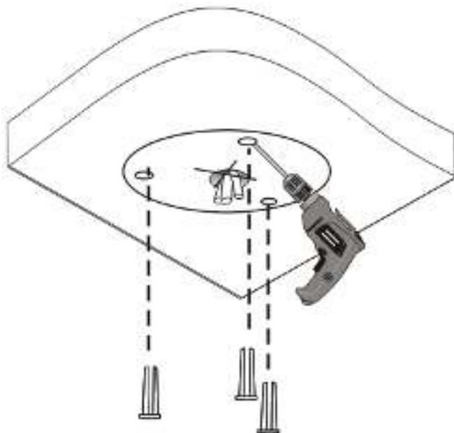
2. Подсоедините все кабели и закрепите основание камеры на поверхности, продев саморезы сквозь отверстия в основании и вкрутив их в дюбеля с помощью отвертки:
