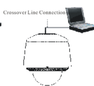
Рисунок 4.2 Соединение с использованием перекрестной линии
