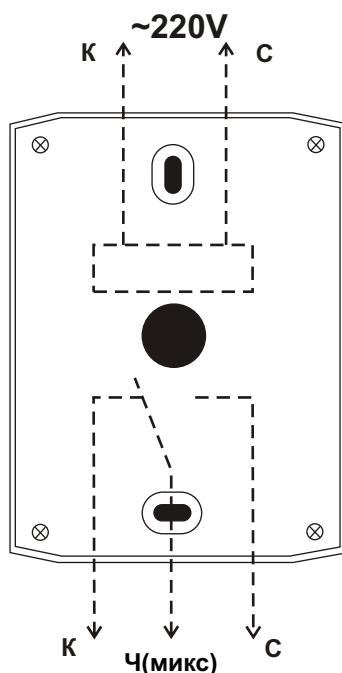
Кабель силового реле (трёхжильный)
