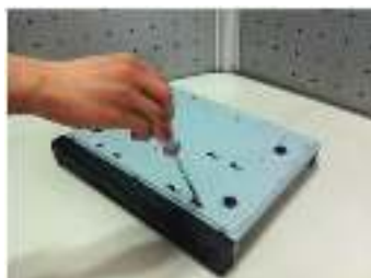
Замацуеце жорсткі дыск на ніжняй панэлі пры дапамозе шруб праз соответствующие адтуліны.
