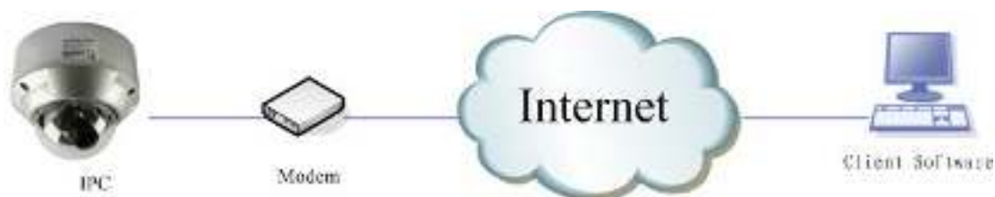
Рис.3.5.4 Подключение камеры с использованием PPPoE dial-up
