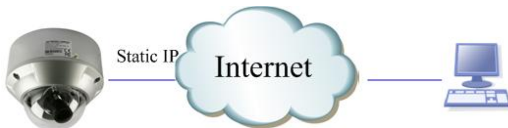
Рис.3.5.2 Подключение напрямую со статическим IP
