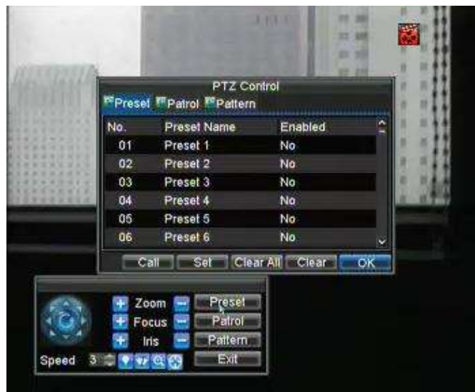
Рис.4. Меню настройки предустановок PTZ камер.
