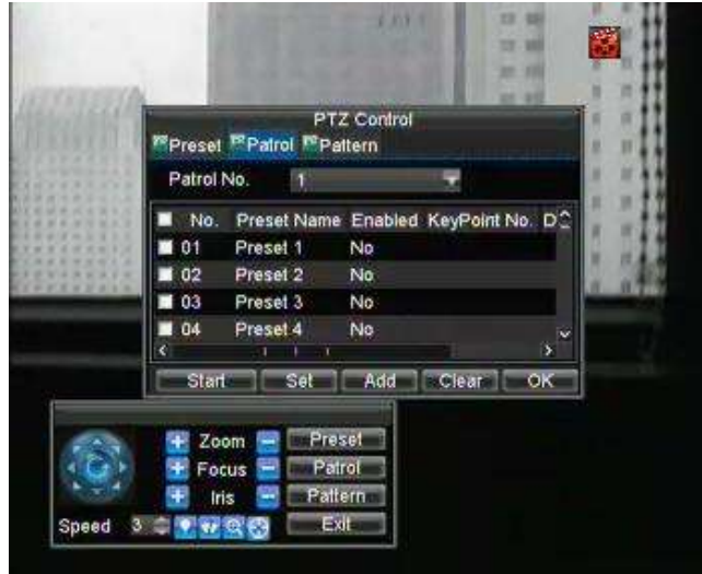
Рис. 7. Меню управления зонами обхода
