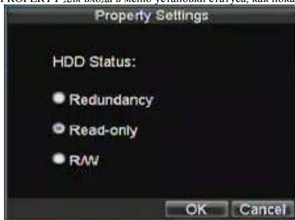
Рис. 3. Меню установки статуса жесткого диска
