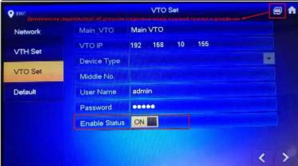
После этого переключаем на основном домофоне ползунок в пункте “VTO Set” на OFF, ожидаем, переключаем на ON.
