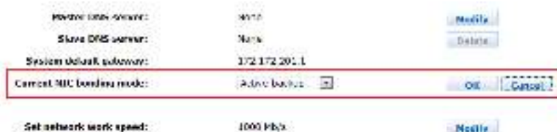
Рисунок 4. 4 Изменение режима связывания NIC
