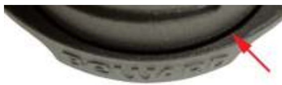
б) Неправильная установка, есть зазор.
