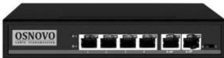
Рис.1 Коммутатор SW-20600/A(80W) (вид спереди)
