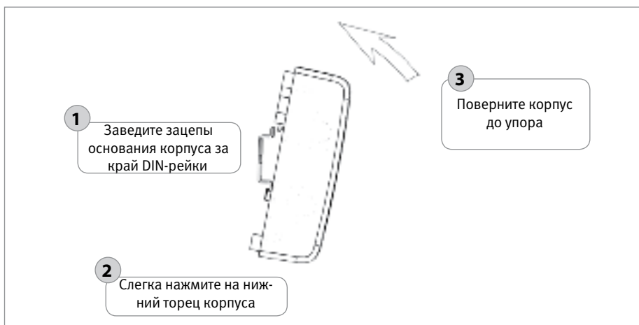
Рисунок 23. Порядок установки прибора на DIN-рейку
