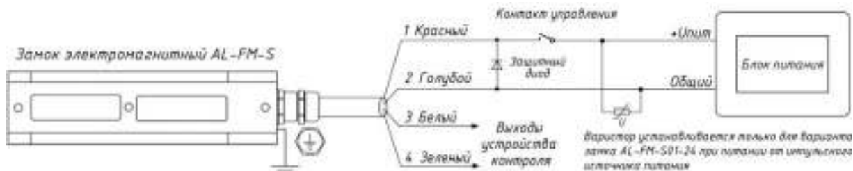
Рисунок 9 - Схема подключения изделия для вариантов «Н» и «G»
