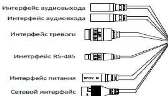
Рисунок 2-3 Кабели тепловизионной купольной камеры
