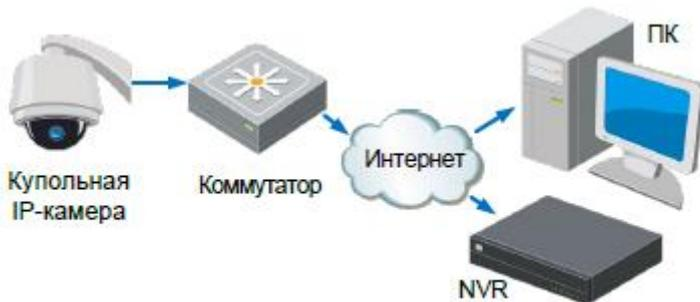
Рисунок 4-1 Подключение через LAN
