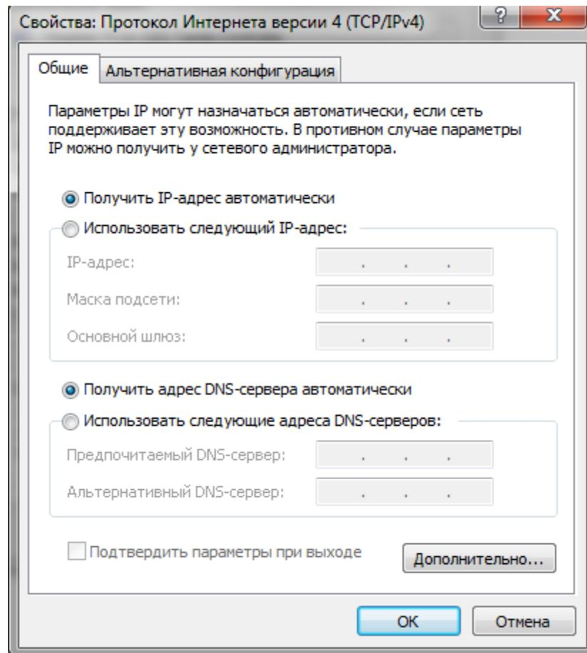
Выберите пункт «Использовать следующий IP-адрес» , выбрав его строки IP-адрес, Маска подсети, Основной шлюз- будут доступны для заполнения.
