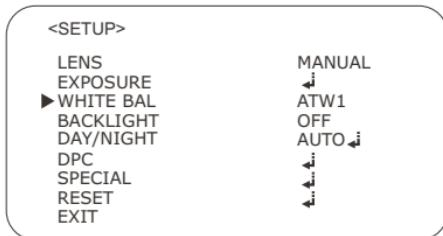
**ATW (автоматическое отслеживание баланса белого):** Этот режим может быть использован в пределах цветовой температуры 1800 ° K ~ 10,500 ° K (например, флуоресцентный свет, на улице, натриевая лампа и т.д.)
