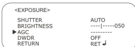
Эта функция может работать в широком диапазоне освещенности, автоматически увеличивая чувствительность камеры в условиях низкой освещенности, повышая выходной видеосигнал, что позволяет получить яркое и четкое изображение.
