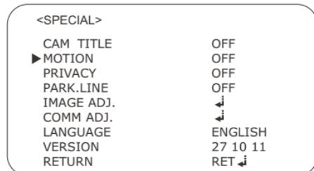
Данная видеокамера имеет функцию, которая позволяет следить за движением объектов в выбранной области на экране.
