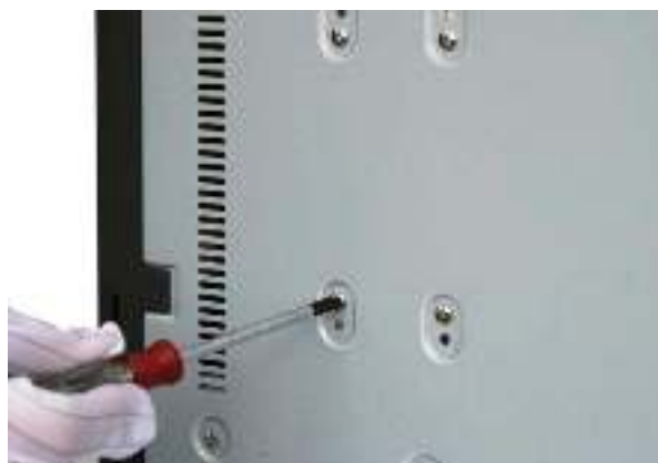
Закрепите HDD и закрутите крышку видеорегистратора
