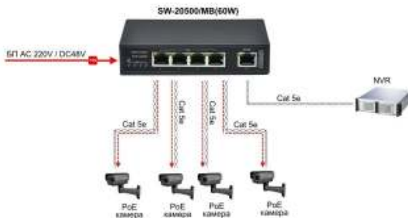
Рис.4 Типовая схема подключения коммутатора SW-20500/MB(60W)
