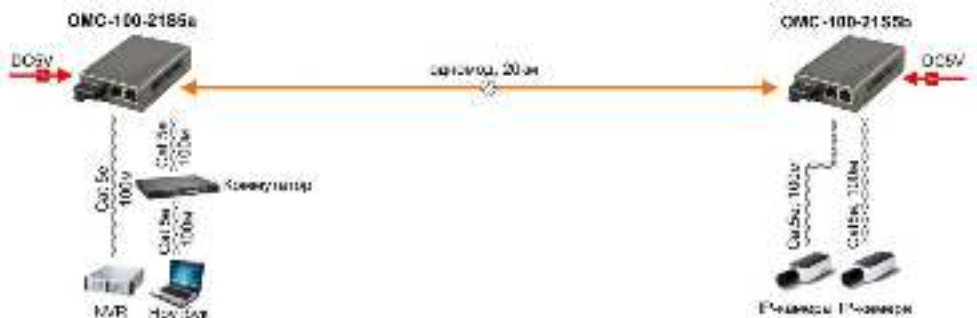
Рис. 7 Схема подключения медиаконвертеров OMC-100-21S5a (OMC-100-21S5b)
