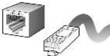
Рис. 10 Разъём RJ45 с пронумерованными контактами.
