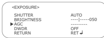
Эта функция может работать в широком диапазоне освещенности, автоматически увеличивая чувствительность камеры в условиях низкой освещенности, повышая выходной видеосигнал, что позволяет получить яркое и четкое изображение.
