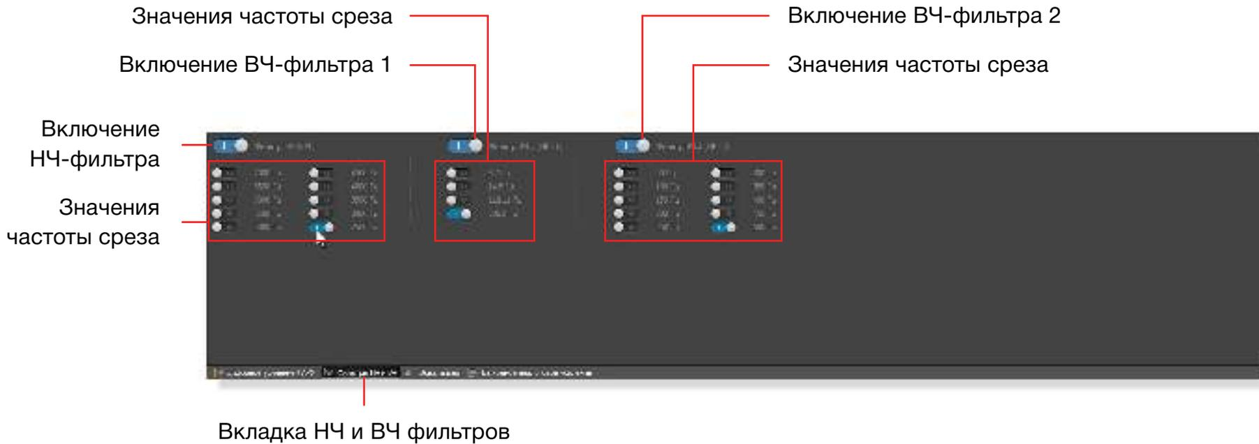
Вкладка НЧ и ВЧ фильтров содержит 1 фильтр низких частот и 2 фильтра высоких частот.
