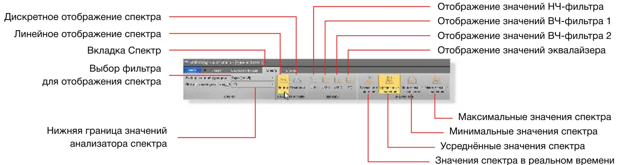
Во вкладке **Спектр** можно задать параметры, по которым будет отображаться спектр сигнала.
