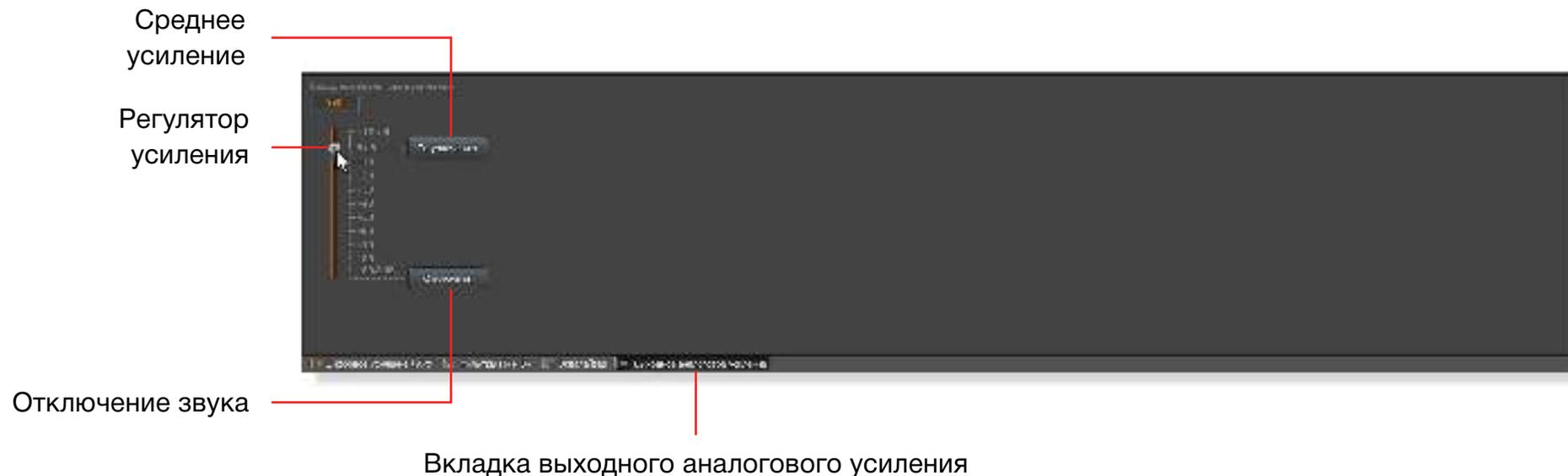
При помощи этого регулятора можно усилить или ослабить сигнал, который поступает на линейный аудиовыход.
