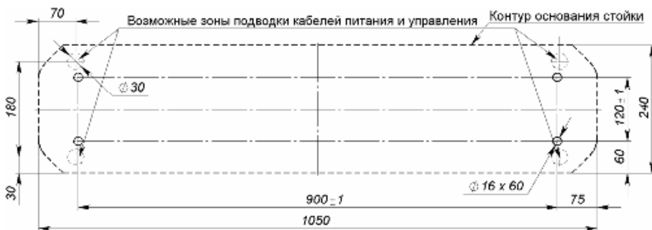
Рисунок 9 Схема разметки для установки стойки турникета
