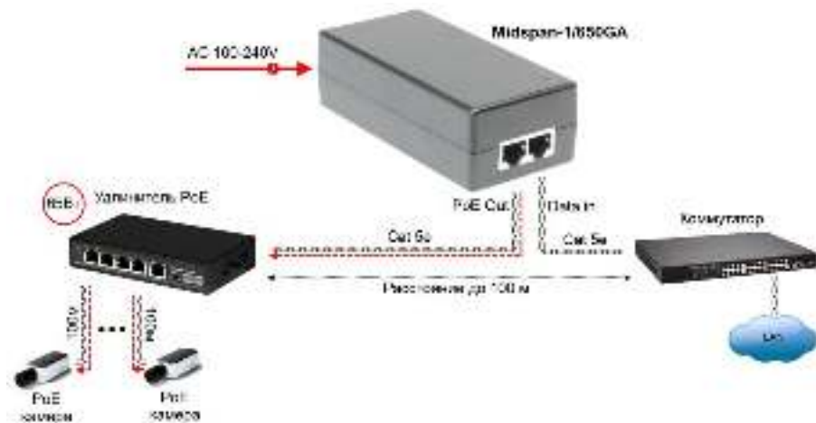
Рис.5 Типовая схема подключения инжектора Midspan-1/650GA с удлинителем с питанием по PoE
