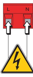
Вход для подключения электропитания ~220В, 50/60 Гц
