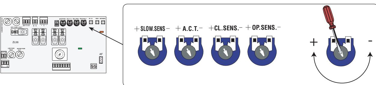
SLOW.SENS. - регулировка чувствительности токовой системы обнаружения препятствий при замедлении. При превышении установленного уровня, система изменяет движение ворот на противоположное.
