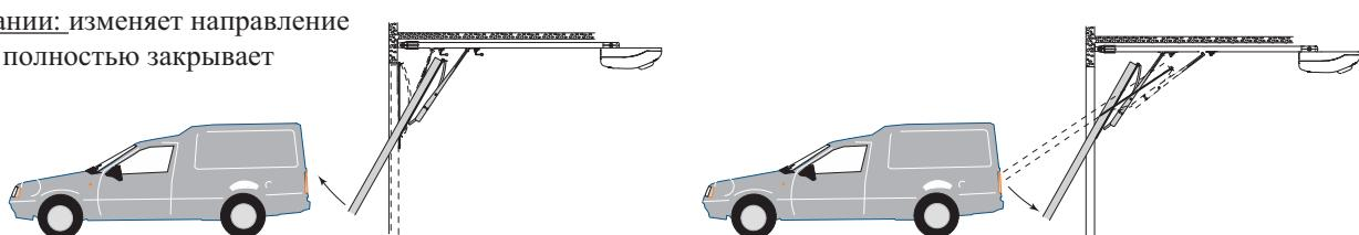
при закрывании: изменяет направление движения и полностью открывает ворота.
