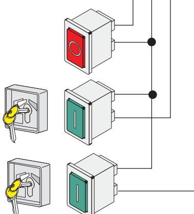
Ключ-выключатель или кнопка (контакты НО) - кнопка управления для частичного открывания ворот.
