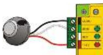
Контроллер поддерживает режим прохода по ключу с предварительным вводом пароля (при подключении считывателя Matrix-IV EH Keys).
