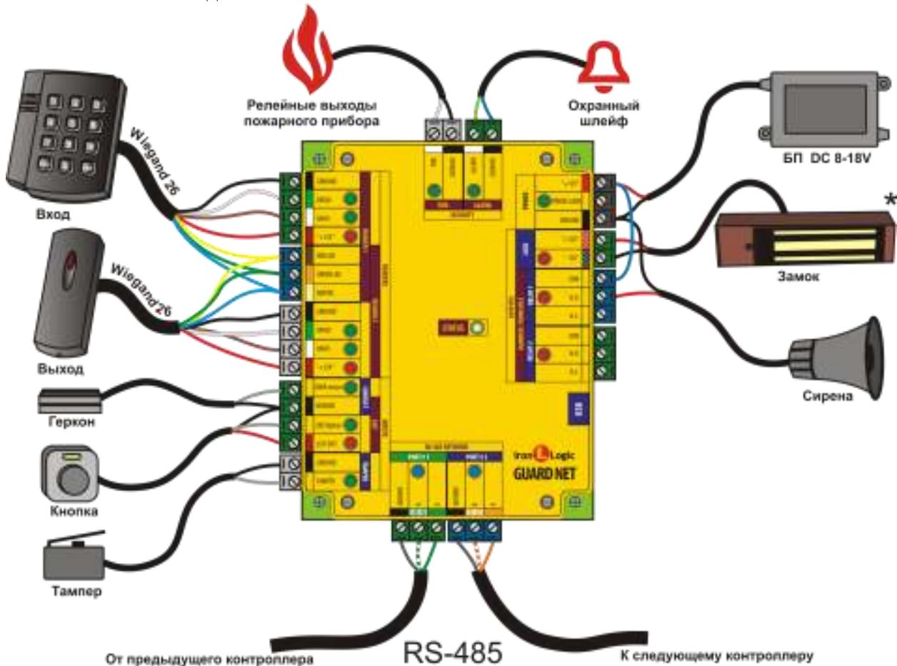
**Считыватели** – могут быть использованы любые считыватели, работающие по протоколам Wiegand 26 или Dallas Touch Memory. На схеме показан пример подключения считывателя работающего по протоколу Weigand. Для подключения по протоколу Dallas используется следующая схема:
