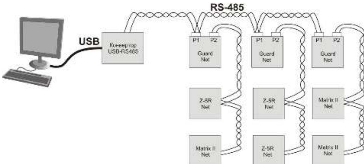
При выходе из строя одной из “ветвей” структуры, остальные продолжают работать в нормальном режиме. Это повышает надёжность системы и снижает затраты на обслуживание.
