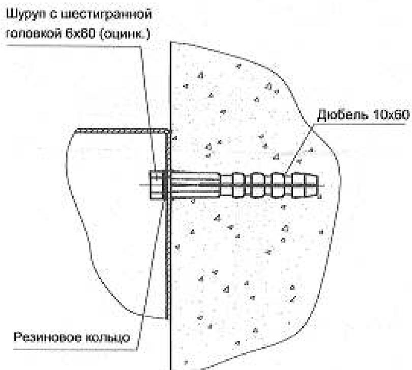
Рисунок 3.2.1 - Установка на стену без зацепов
