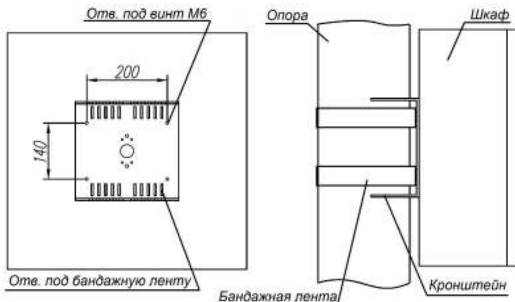
Рисунок 3.1.1 - Установка шкафа на опору при помощи кронштейна TFortis-3
