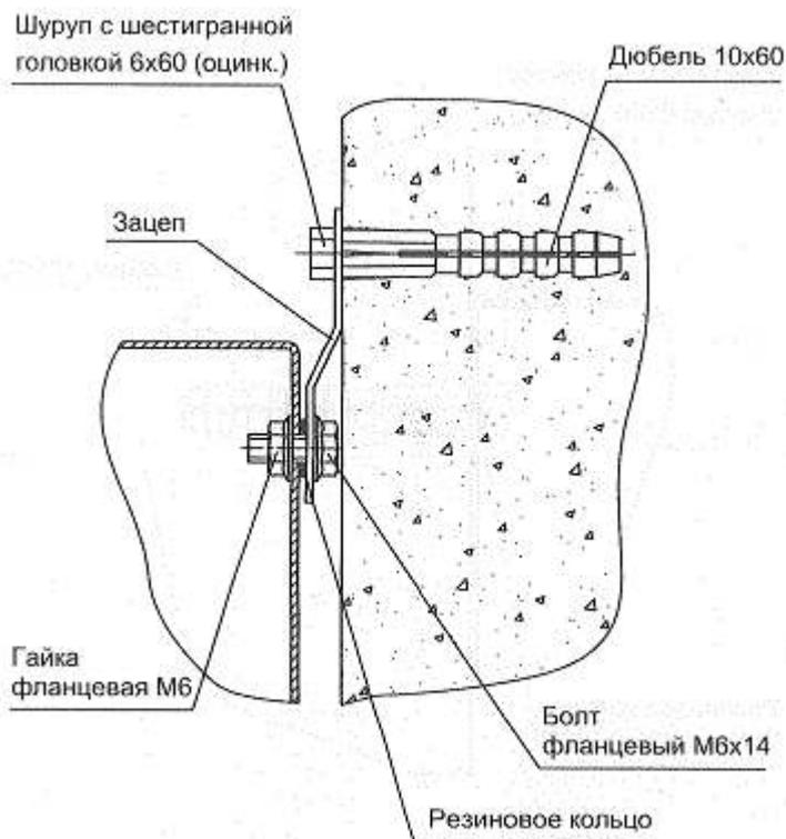
Рисунок 3.2.2 - Установка на стену с зацепами
