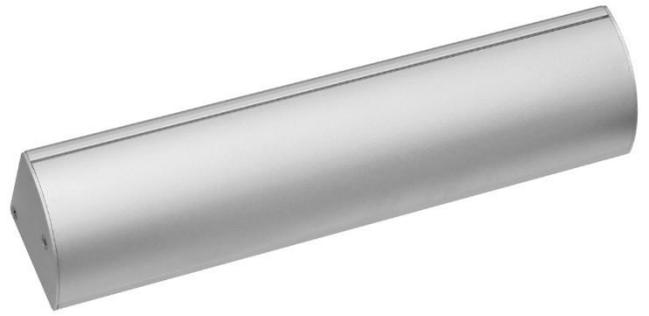
Кронштейн LC типа применяется для крепления электромагнитных замков на дверной коробке двери, открывающиеся наружу, когда электромагнитный замок нельзя установить непосредственно на коробку. Данный кронштейн имеет крышку, которая позволяет скрывать монтажные элементы замка, что придает более эстетичный внешний вид и защищает проводку от преднамеренного повреждения.
