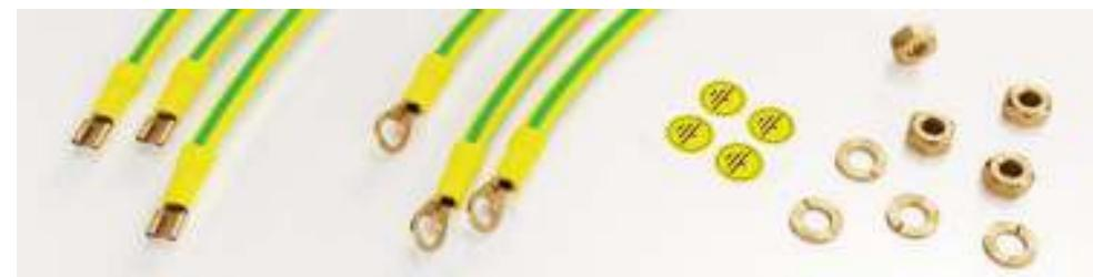
В комплекте изделия имеется 6 заземляющих проводов, а также шайбы и гайки для их крепления. Провода с одной стороны окончаны разъемными соединителями, а с другой – наконечниками с кольцом.
