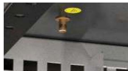
Как крыша, так и основание шкафа содержат по 2 резьбовые шпильки (всего 4 шт.), через которые с помощью проводов заземления можно подключить все металлические элементы шкафа, оснащенные наконечниками под разъемный соединитель (одно- или двусторонние контакты типа лепесток).
