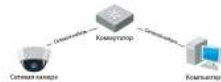
Рисунок 3-2 Соединение через коммутатор или роутер
