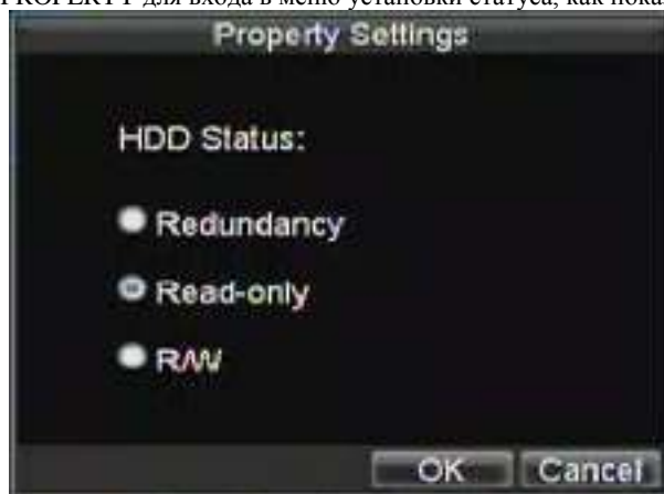
Рис. 3. Меню установки статуса состояния жесткого диска
