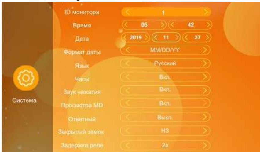
**[ID монитора]** означает идентификатор внутреннего устройства, диапазон от 1 до 6. 1 означает, что монитор является основным, 2-6 означает, что внутренние мониторы являются дополнительными. Каждый блок поддерживает максимум до 6 мониторов.
