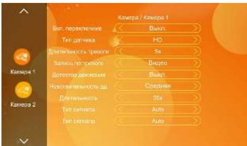
Данный интерфейс может устанавливать параметры Камера 1 и Камера 2 соответственно. **[Вкл. переключение]** указывает состояние этого канала. Если установлено значение «Вкл.», камера может использоваться в обычном режиме. Если установлено значение «Выкл.», камера отключена.
