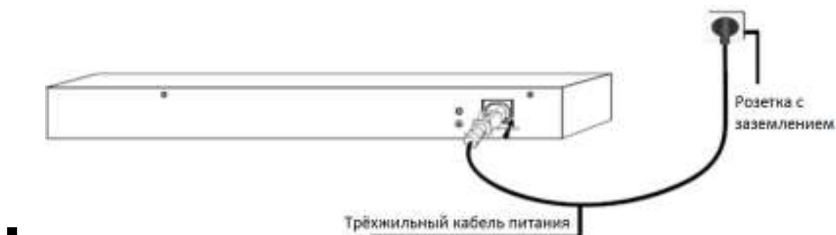
Рисунок 2.8 Заземление с использованием трёхжильного кабеля питания
