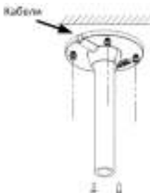
Рисунок 2-33 Установка подвесного кронштейна
