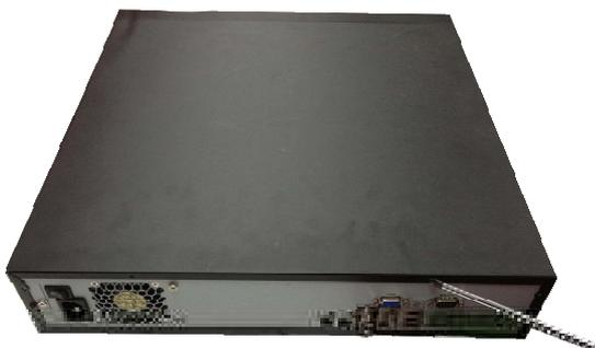
Открутите винты крепления крышки на нижней части корпуса.
