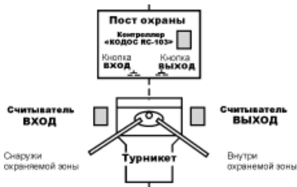
Рисунок 10 — Два внешних считывателя, контроллер в режиме работы с внешними считывателями серии «КОДОС RD»
