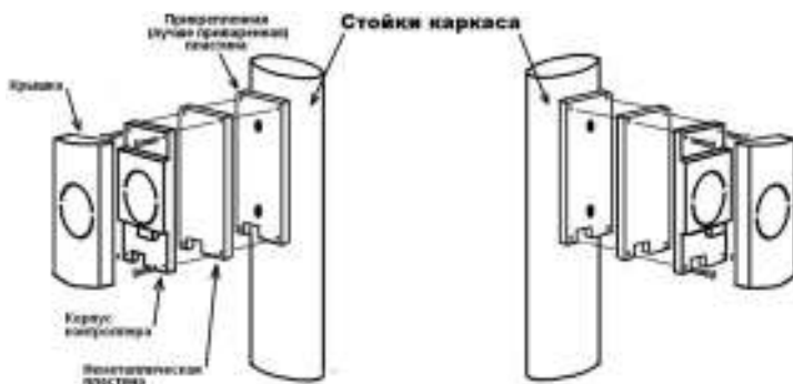
Рисунок 20 – Установка контроллера на общий каркас
