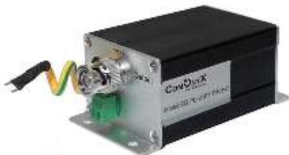
Грозозащита линии 12/24Вольт и коаксиального кабеля 75 Ом. Поддержка AHD до 5Мр и CVBS сигналов. Падение полезного сигнала не более 0,2дБ. Время срабатывания до 1нс, для клеммной колодки до 25нс. Максимальный ток разряда для клеммной колодки и разъема BNC 10КА. Вес 180г, размеры 104x51x38мм. Металлический кожух IP20, от -20 до +50град, крепление на стену.
