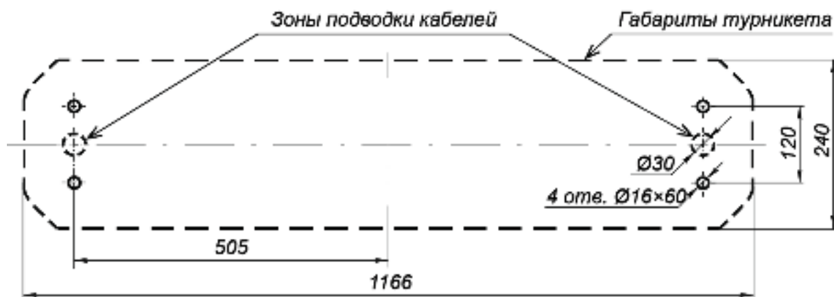
Рисунок 14. Схема разметки для установки стойки турникета
