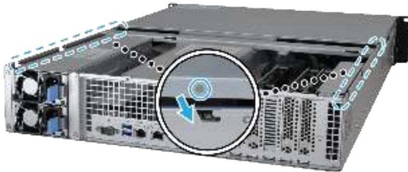
б Установите на место и затяните винт, вывинченный в ходе выполнения шага 2-а.
