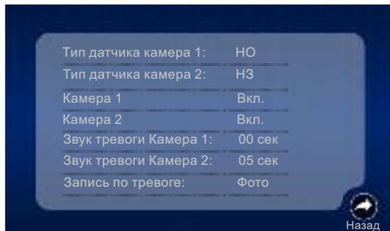
**Тип датчика Камера 1:** Выбор Н.О., Н.З. контактов датчика движения или Выкл. для первой камеры.
