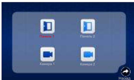
В данном подменю настройки яркости, контрастности и насыщенности могут регулироваться в отдельности для каждого канала: Панель 1, Панель 2, Камера 1 и Камера 2 для оптимального отображения на экране. Наведите курсор на Панель 1, Панель 2, Камера 1 или Камера 2 и нажмите «⚙️», чтобы войти в меню настройки.
