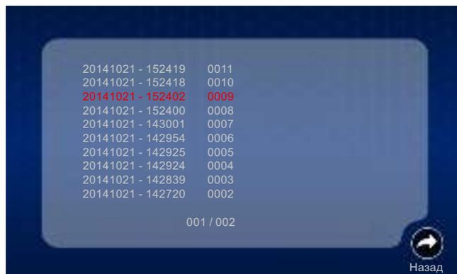
**Примечание:** Если на память устройства сохранено более 20 фотографий, они автоматически будут перенесены на SD карту, когда домофон перейдет в режим ожидания (при установленной SD карте).
