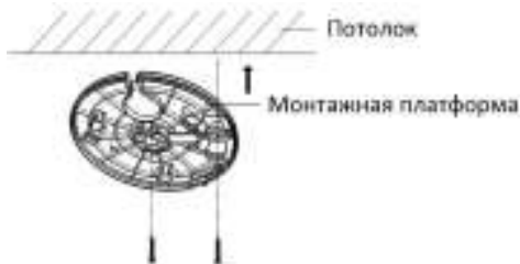
Рисунок 2-3 Установка монтажной платформы
