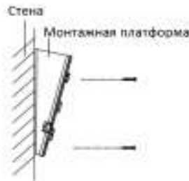
Рисунок 2-8 Установка наклонной монтажной платформы
