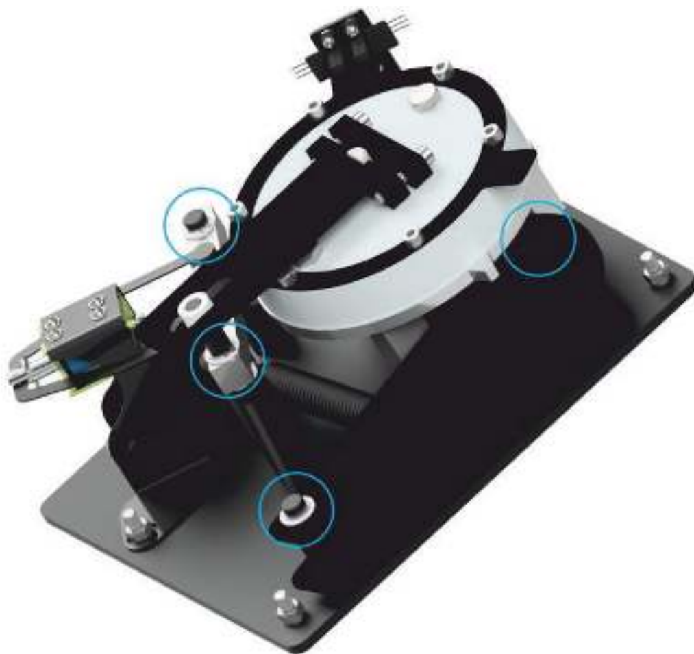
Рисунок 12.5.1 – Места смазки подвижных частей
