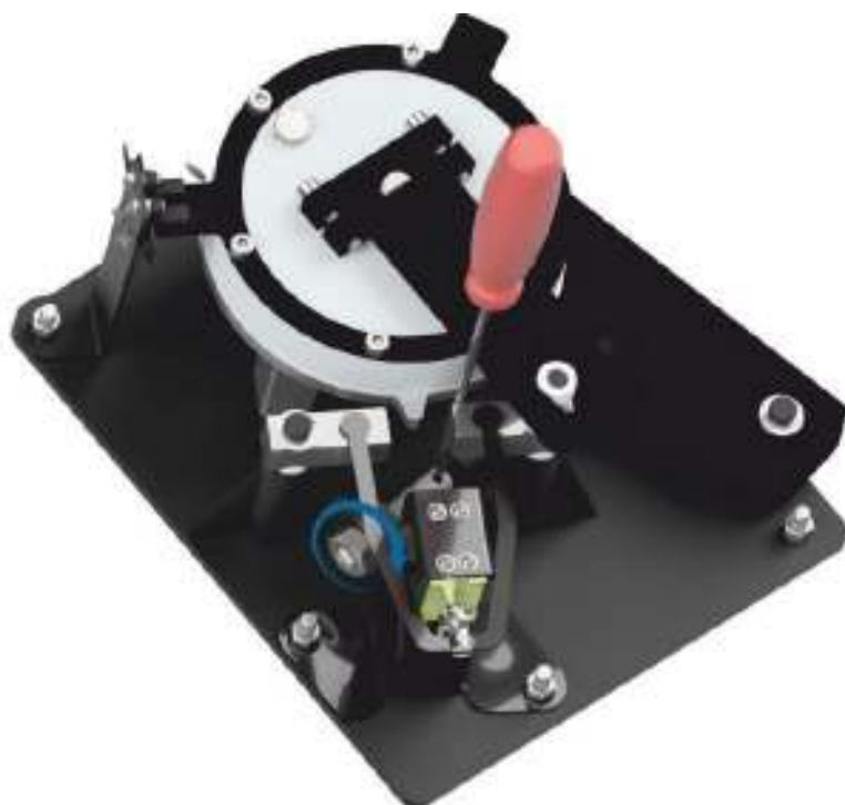
Рисунок 12.4.1 – Регулировка натяжения пружины доводчика
