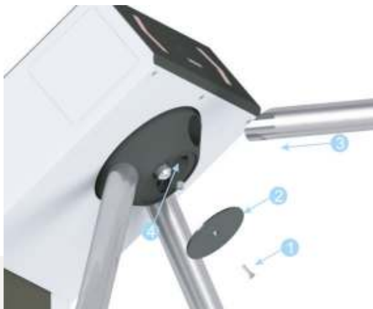
Рисунок 7.5.1 - Установка стандартной преграждающей планки
