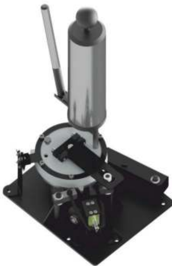
Рисунок 12.3.3 – Доливка демпферной жидкости.
