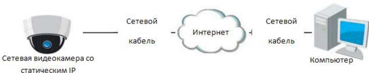
Рисунок 3.4.1: Доступ к сетевой камере со статическим IP напрямую.
