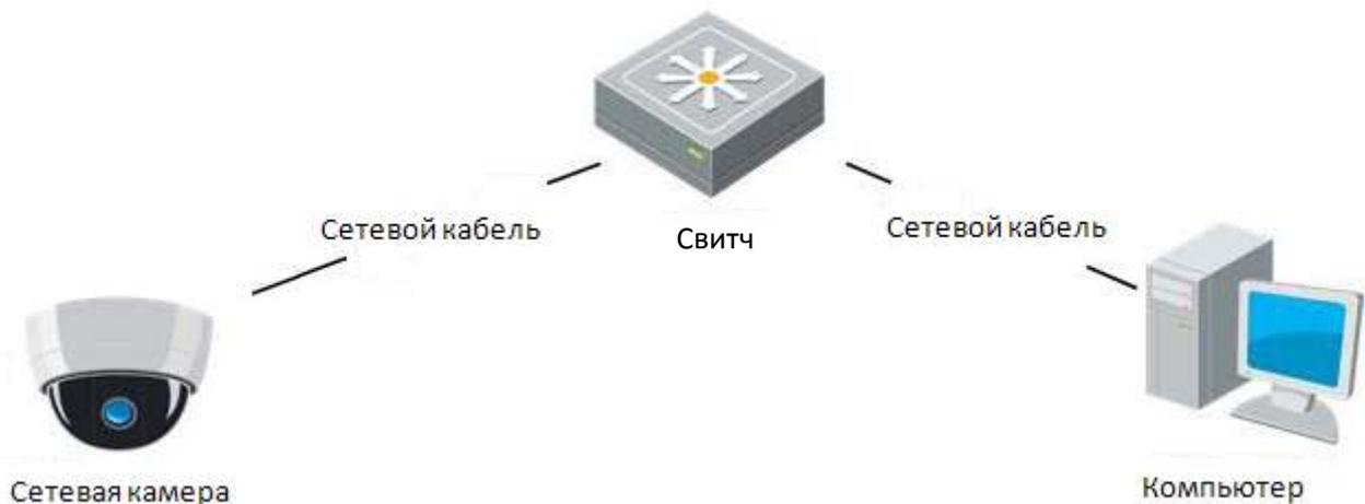
Рисунок 3.1.2: Подключение с использованием прямого кабеля.
