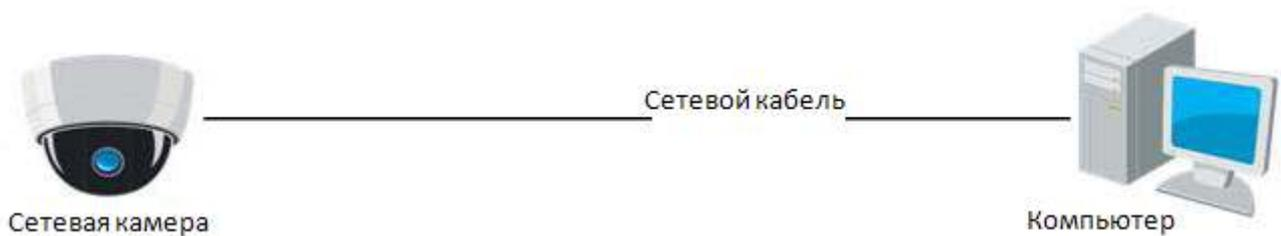
Рисунок 3.1.1: Подключение с использованием перекрестного кабеля.
