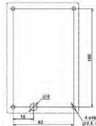
Рисунок 7 – Установочные размеры
