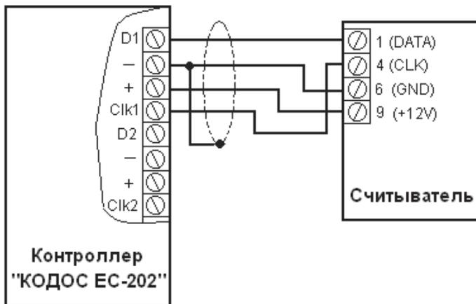
Рисунок 8 – Пример схемы экранирования
