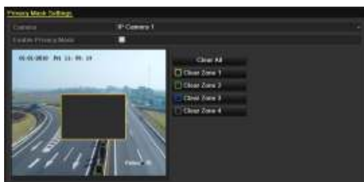
Рис. 13. 3 Установка маски приватности
