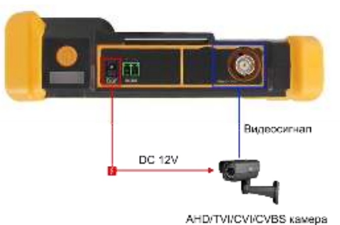
Рис. 9 Подключение AHD/TVI/CVI/CVBS видеокамеры к тестеру
